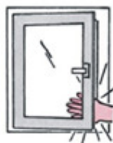
Pas på! Et vindue, der slår i kan føre til skader. Grib ikke mellem ramme og karm, når vinduet lukkes.
